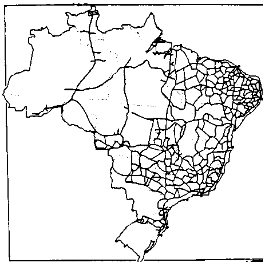
Figura 1.4 - Rede de nivelamento geodésico executado pelo IBGE
